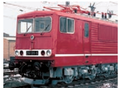
LEW Hennigsdorf BR 155/250 Deutsche Reichsbahn Germany ECFB 1110-127C, 850 kW, 1,310 r.p.m.
